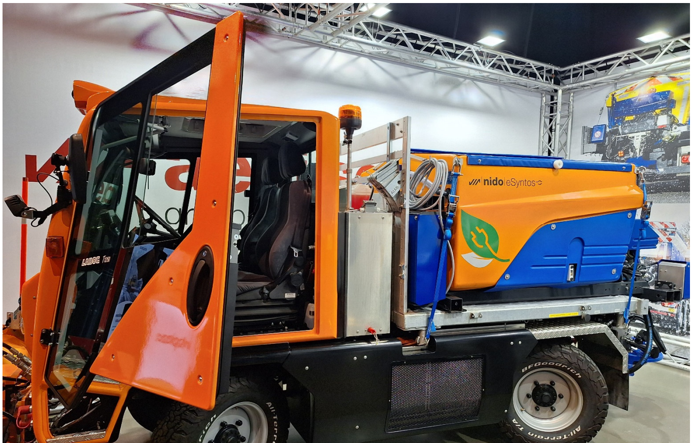
Figuur 3: elektrisch voertuig én strooi-installatie
